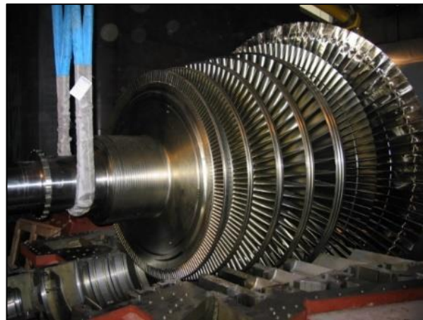
Figure 12 : Rotor du Groupe Turbo Alternateur (GTA)
