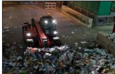
Figure 5 : Photo de la reprise de la collecte sélective par un engin pour alimenter la chaîne
