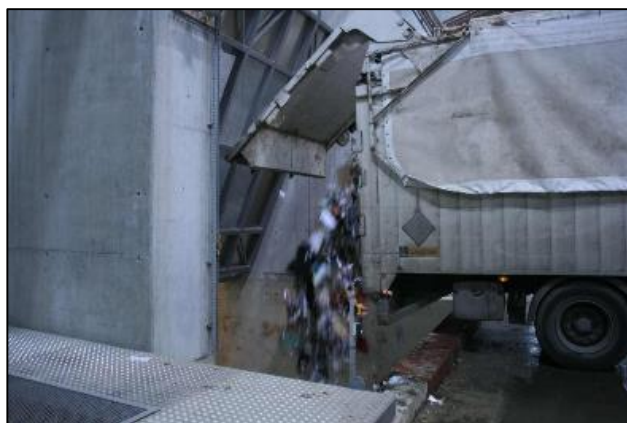
Figure 9 : Déchargement d'ordures ménagères en fosse
